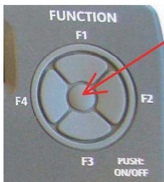
Pulsando la tecla central ON/OFF durante 3 segundos, se obtiene el encendido del grupo frigo.
