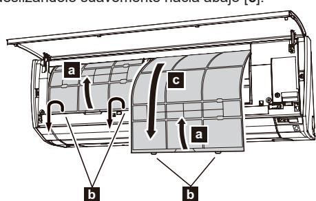
(3) El soporte del filtro y el filtro de limpieza del aire están acoplados en la parte posterior del filtro de aire. Retírelos del filtro de aire desacoplando cada esquina del soporte del filtro [d].
