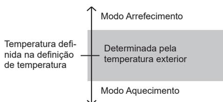
Quando o modo Auto é seleccionado em primeiro lugar, a ventoinha irá funcionar a uma velocidade reduzida durante alguns minutos, período em que a unidade interior detecta as condições ambientais e selecciona o modo de funcionamento.
