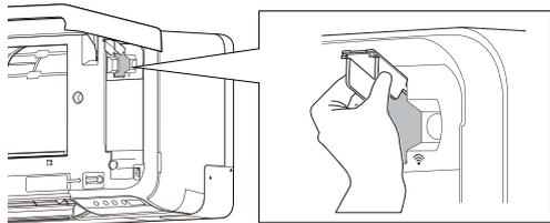
4. Conecte o adaptador WLAN no slot de conexão da unidade interna na direcção como mostrada na figura.
