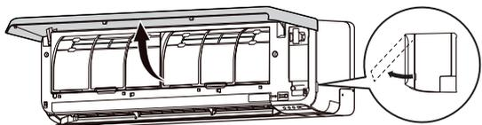
3. Abra a tampa do adaptador WLAN até que ela se encaixe.
