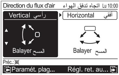
عند تحديد [Ajust. position]: بالضغط على [زر Entrée] ، اضبط اتجاه تدفق الهواء المطلوب. عند الضغط على [زر Entrée] ، يومض مؤشر ضبط الموضع ويتحرك السهم الذي يشير إلى اتجاه تدفق الهواء بموضع واحد
