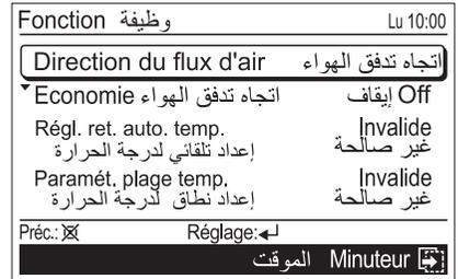
2 تفتح شاشة "اتجاه تدفق الهواء". في شاشة "اتجاه تدفق الهواء" ، يتم عرض اتجاه تدفق الهواء القابل للتعديل على الوحدة الداخلية المقابلة وحركتها الحالية المحددة. حدد [عمودي] أو [أفقي] باستخدام [زر المؤشر (يسار / يمين)].
