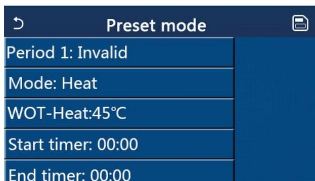
L'opzione **“Mode”** (“Modalità”) si usa per preimpostare la modalità; **“WOT-Heat”** (“TAU riscaldamento”) si usa per impostare la temperatura dell'acqua calda/fredda in uscita; **“Start timer”** (“Inizio timer”)/**“End timer”** (“Fine timer”) si usano per impostare l'ora. Dopo di ciò, fare clic sull'icona di **“Salvataggio”** per salvare tutte le impostazioni.
