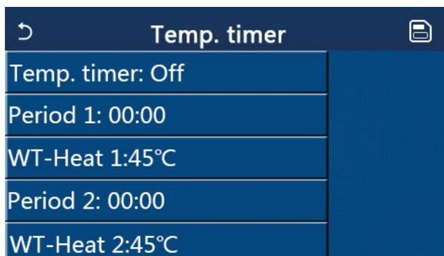
Selezionare **“Period 1”/“Period 2”** (Periodo 1/Periodo 2): comparirà una finestra in cui si può impostare il periodo di tempo. Quindi selezionare **“WT-Heat1/ WT-Cool 1/2”** (“TA per riscaldamento 1/TA per raffrescamento 1/2”): comparirà una finestra in cui si può impostare la temperatura.
