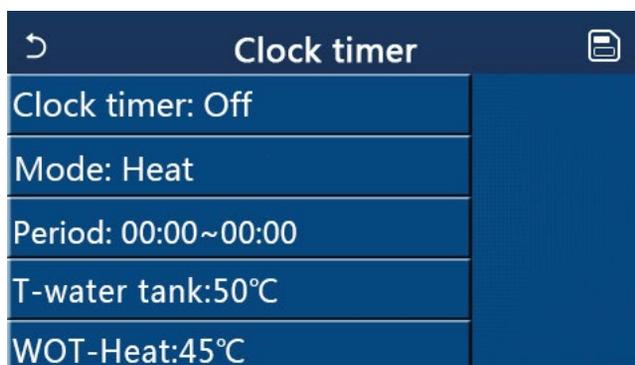
3. L’opzione **“Mode”** (“Modalità”) si usa per regolare la modalità desiderata; **“WOT-Heat”** (“TAU riscaldamento”) e **“T-water tank”** (“Temperatura serbatoio dell’acqua”) si usano per impostare la temperatura dell’acqua corrispondente; **“Period”** (“Periodo”) si usa per impostare il tempo. Dopo di ciò, fare clic sull'icona di **“Salvataggio”** per salvare tutte le impostazioni.
