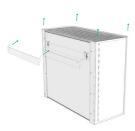
1- Retire o equipamento da parede, levantando-o ligeiramente para retirar os ganchos da peça de fixação na parede do equipamento.
