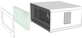
3 - Per accedere al prefiltro, rimuovere il pannello di aspirazione dell'aria svitando le 6 viti.
