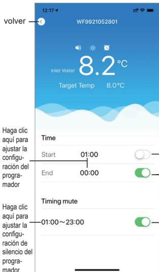
Fig.19 Interfaz de configuración del programador
