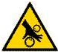
**ADVERTENCIA: Durante el trabajo, está absolutamente prohibido retirar las resguardos de seguridad, debido a la presencia de piezas móviles que pueden provocar el aplastamiento de manos.**
