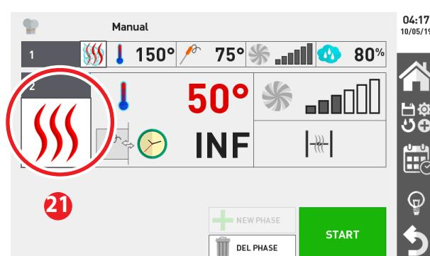
Regolazione umidità - Humidity control - Réglage de l'humidité - Feuchteregelung - Ajuste de la humedad - Regulace vlhkosti - Regulacja wilgotności
