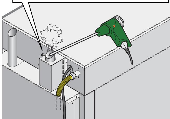
**Apparecchiatura a gas : misura dei prodotti della combustione - Gas appliances: measurement of combustion products - Equipement gaz : valeur des produits de combustion - Gasbetriebener Apparat: Messung der Verbrennungsprodukte - Equipo de gas: medida de los productos de la combustión - Plynové spotřebiče: měření spalovacích produktů - Urządzenia gazowe: pomiar produktów spalania**
