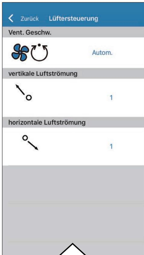
Durch Auswahl der einzelnen Elemente, wie auf dem Bildschirm gezeigt, können Sie die Lüftergeschwindigkeit und die Luftstromrichtung einstellen. Detaillierte Informationen zu den einzelnen Einstellungen finden Sie in der Bedienungsanleitung der Klimaanlage.
