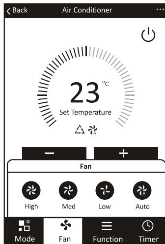
4. El otro control de función puede seleccionarse por el botón "Function", Sleep, Turbo, ECO, UP-DOWN, LEFT-RIGHT.
