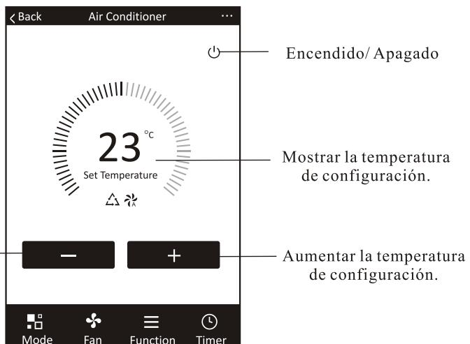
Disminuir la temperatura de configuración.
