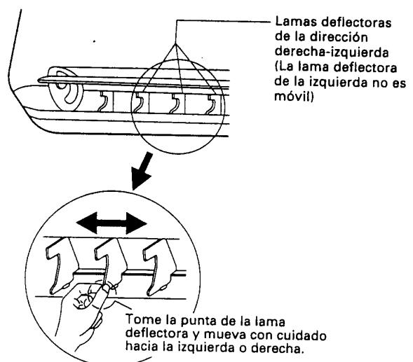
Con el fin de alzar la eficacia de los modos de refrigeración y deshumectación, las lamas deflectoras de la dirección del flujo de aire deben ajustarse dentro de los márgenes siguientes:
