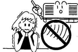
**No inserte los dedos ni otros objetos en el orificio de salida ni en las rejillas de entrada.**
