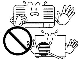
**No debe poner en funcionamiento el acondicionador de aire ni pararlo enchufando y desenchufando el cable de la alimentación.**
