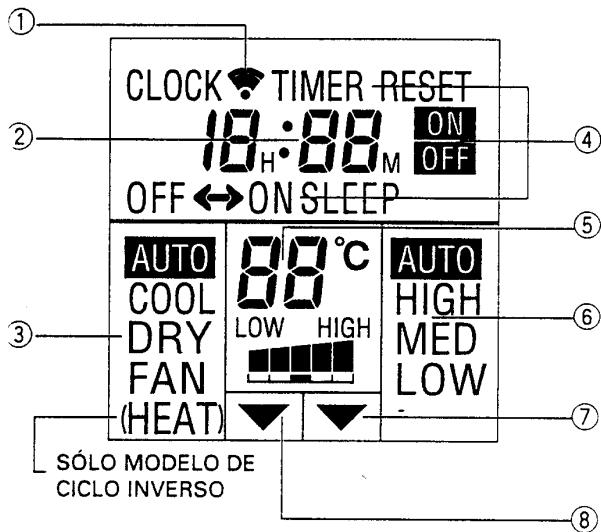
La ilustración muestra la visualización de los controles con todos los indicadores encendidos; sin embargo, en la realidad, sólo se visualizan los indicadores necesarios.
