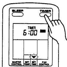
**2 Presione el botón del temporizador (TIMER) para seleccionar el funcionamiento de temporizador de conexión (ON).**
