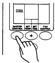
Si desea cambiar las condiciones de funcionamiento (modo, velocidad del ventilador, ajuste del termostato, láminas deflectoras orientables automáticas) después de haber hecho el ajuste del temporizador, espere a que reaparezca toda la visualización, y presione los botones apropiados para cambiar el funcionamiento como desee.
