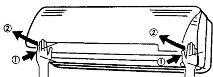
Presione ambos lados inferiores de la rejilla de entrada hasta oír un sonido seco de confirmación y la rejilla se fijará en su posición.
