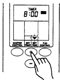
**3 Emplee los botones de ajuste de la hora (SET TIME) para ajustar la hora de conexión (ON) deseada.**
