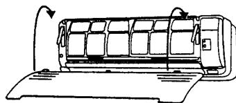
2. Presione ambos lados inferiores de la rejilla de entrada hasta oír un sonido seco de confirmación y la rejilla se fijará en su posición.
