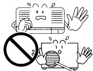
**Ne mettez pas le climatiseur en service ou hors service en branchant ou débranchant le cordon d'alimentation.**
