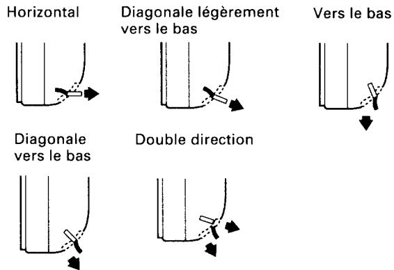
Pour renforcer l'efficacité des modes Refroidissement et Déshumidification, les volets de direction de flux d'air doivent être ajustés dans les plages suivantes:
