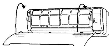
2. Poussez sur les deux bords inférieurs de la grille d'admission jusqu'à entendre un déclic et la grille sera verrouillée.
