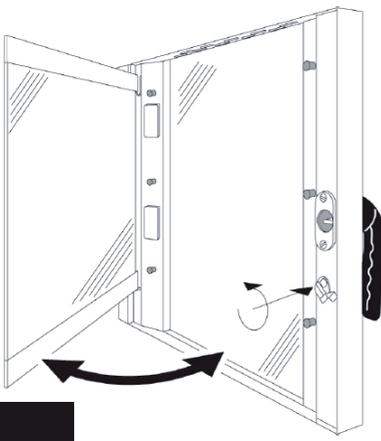
Se puede limpiar el vidrio de la puerta ya sea por el lado externo que en el lado interno. Para ese fin se debe girar en el sentido del reloj la parada que tiene el vidrio interno en su lugar y, una vez abierto, se limpiará con un detergente idóneo.
