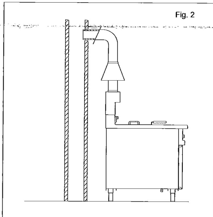
L'installazione degli apparecchi con scarico dei gas combusti verso l'esterno tramite un camino deve essere fatta come indicato in figura:
