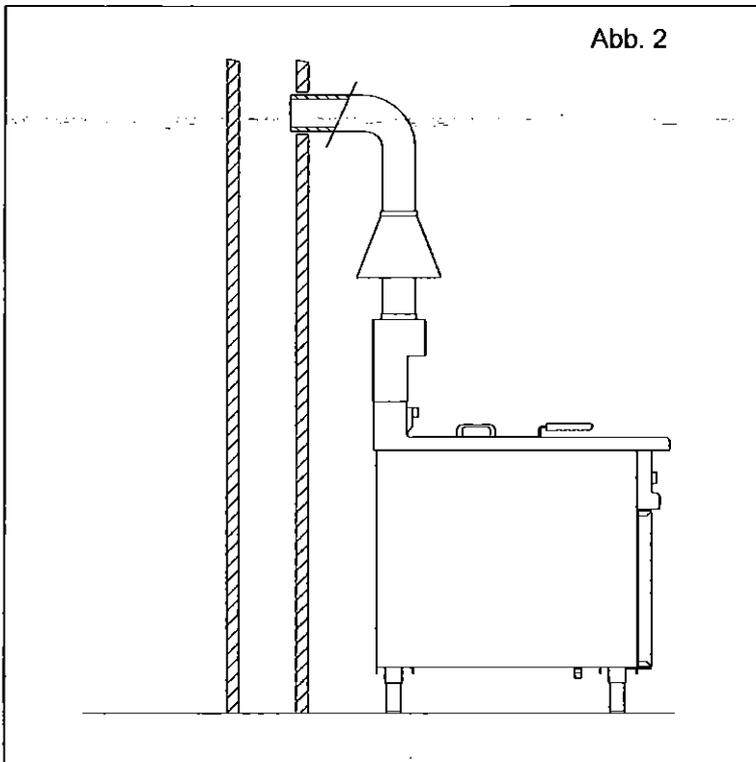
Die Installation von Geräten mit Ablass der Verbrennungsgase nach außen über einen Schornstein muss wie in der Abbildung gezeigt ausgeführt werden.
