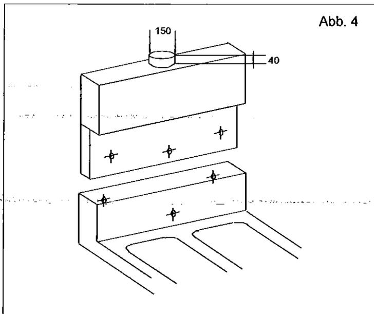
Zum Montieren des Abzugrohrs wie folgt vorgehen (Abb. 4):
