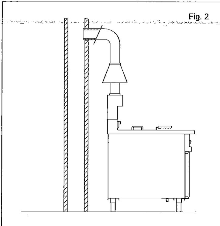
L'installation des appareils avec évacuation des gaz brûlés vers l'extérieur avec une cheminée doit être faite de la façon indiquée sur la figure: Le chemin s'effectue vers l'extérieur ou dans une cheminée avec une conduite appropriée, résistant à une température de 300°C, d'un diamètre égal au champignon (Fig. 2).
