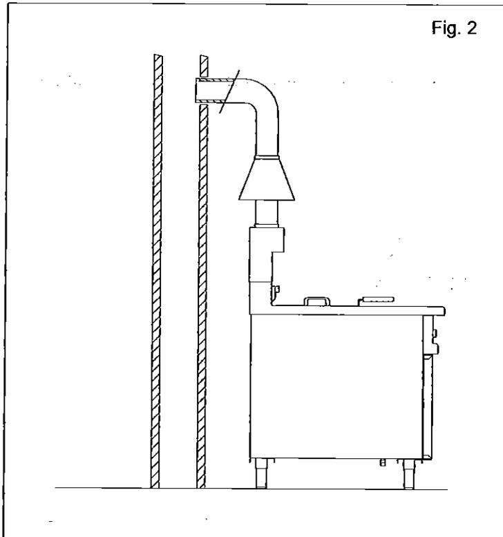
La instalación de los aparatos con evacuación de gases quemados hacia el exterior a través de una chimenea debe realizarse como se indica en la figura:
