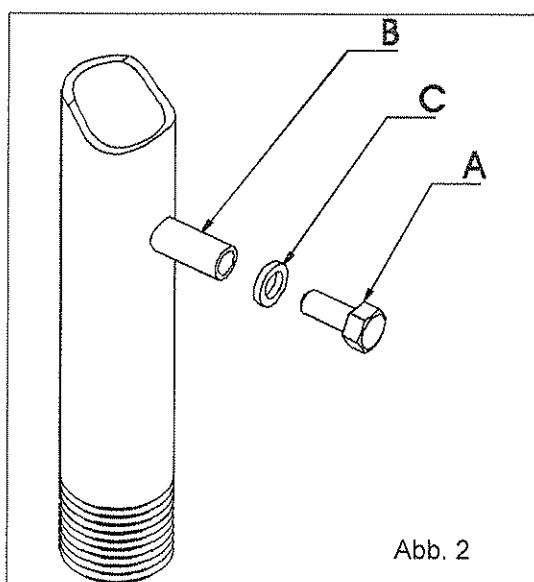
Der Gasdruck muss in Höhe des Druckanschlusses (Bez.B.) gemessen werden, nachdem die Dichtungsschraube (Bez.A) entfernt wurde. Mittels eines Schlauches an den Druckanschluss ein Messgerät (z.B. ein Flüssigkeitsmanometer, mit einer Feinheit von mindestens 0,1mbar) schließen und bei eingeschaltetem Gerät den Eingangsdruck messen. Wenn sich der Druckwert nicht innerhalb der in der Tabelle angegebenen unteren und oberen Grenzen befindet, kann das Gerät nicht endgültig installiert werden.
