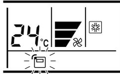
Prima o botão THERMO SENSOR (SENSOR TÉRMICO) para seleccionar se a temperatura ambiente é detectada na unidade interior (sensor remoto) ou no controlo remoto.
