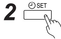
Prima o botão SET BACK (Definição) para alterar a indicação de confirmação de definição.
