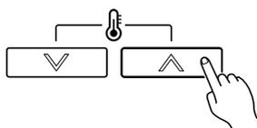
Prima os botões de definição de temperatura para definir a temperatura. (O intervalo de definição de temperatura é o mesmo que o intervalo do modo de operação.)
