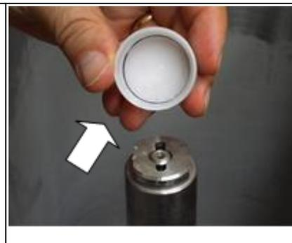
Dévisser la vis qui fixe la cage de protection de la roue mobile de l'agitateur au bac et la tourner dans le sens horaire pour la décrocher des fentes de fixation. Enlever la cage de protection.
