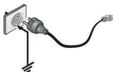
Depois da primeira ligação e depois de cada período de inactividade superior a 8 horas sem alimentação (com a ficha desinserida - tecla "8" em OFF) é necessário **esperar 1 hora e 30 minutos** com a vitrine alimentada (ficha inserida) antes de ligar o compressor.
