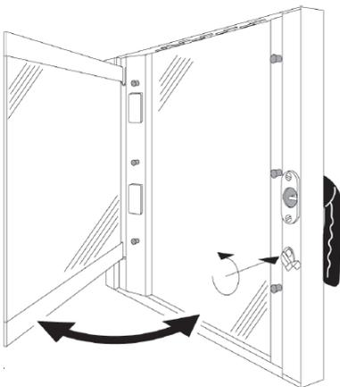
La pulizia del vetro della porta può essere effettuata sia sul lato esterno che su quello interno. A tale scopo si deve ruotare in senso orario il fermo che trattiene in posizione il vetro interno e, una volta aperto il vetro, lo si pulirà con un detergente idoneo.
