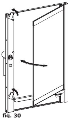
Le nettoyage de la vitre de la porte peut être effectué aussi bien de l'extérieur que de l'intérieur. Pour cette raison, il faut tourner le crochet qui retient la vitre interne en position (fig. 30) et une fois ouverte, il faudra la nettoyer avec un détergent approprié. Il ne faut jamais utiliser des matériaux abrasifs.
