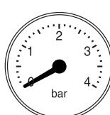
Visualizza la pressione dell'acqua all'interno del circuito di riscaldamento; il valore di tale pressione non deve essere inferiore a 0,8/1 bar (a freddo).
