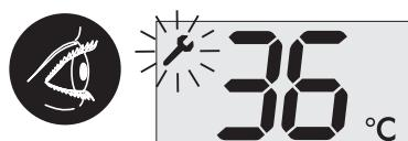
Se l'anomalia provoca il fermo della caldaia o se la stessa è in stand-by, il codice che identifica la causa viene visualizzato, al posto dei gradi centigradi, (per l'elenco dei guasti vedere cap. 5 - "codici di errore" del manuale di istruzioni per l'installatore e il manutentore).
