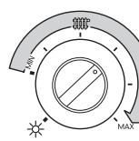
Con il riferimento della manopola posizionato nel campo indicato a lato, la caldaia è in modalità "Inverno", e regola la temperatura dell'acqua del circuito di riscaldamento. La regolazione è compresa fra un minimo di 30°C e un massimo di 85°C
