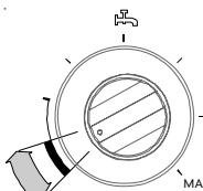
Con il riferimento della manopola posizionato nel campo indicato a lato, la temperatura dell'acqua calda sanitaria è di 38°C.
