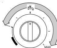
Posizionare la manopola (C) di regolazione della temperatura sanitario, sulla temperatura desiderata **"CONFORT"** da 38°C a 60°C, **ECO-CONFORT** o **ECO**.
