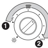
Per il funzionamento in modalità riscaldamento la manopola (B) deve essere posizionata nel campo indicato in figura.
