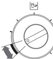
Con il riferimento della manopola posizionato nel campo indicato a lato, la temperatura dell'acqua calda sanitaria è di 38°C.
