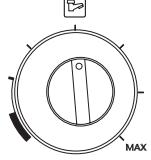
Nel caso di DUCHESS EVO 24 S la funzione è attiva solamente se la caldaia è collegata ad un bollitore esterno. Per mezzo di questa manopola è possibile regolare la temperatura di prelievo dell'acqua calda sanitaria:
