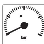
Visualizza la pressione dell'acqua all'interno del circuito di riscaldamento; il valore di tale pressione non deve essere inferiore a 0,8/1 bar (a freddo). Se la pressione dovesse essere inferiore a 0,8/1 bar è necessario provvedere al ripristino del corretto valore agendo sul rubinetto di carico impianto. Questa operazione deve essere eseguita a freddo.
