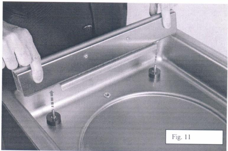
3. SUBSTITUA AS RESISTENCIAS ELECTRICAS (FIG. 11) A BARRA DE COLAGEM EM TEFLON (FIG.11) AS BARRACHAS (2,FIG.10) DE 200/200 HORAS DE TRABALHO
