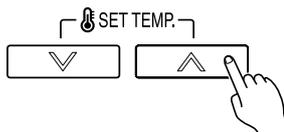
Prima os botões de definição de temperatura para definir a temperatura. (O intervalo de definição de temperatura é o mesmo que o intervalo do modo de operação.)
