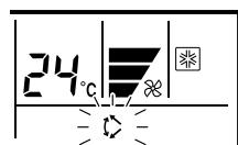
Premere il tasto Oscillazione verticale e direzione flusso d'aria. L'indicatore Oscillazione verticale lampeggiava ogni volta che viene premuto il tasto Oscillazione verticale e direzione flusso d'aria.
