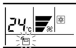
Prima o botão THERMO SENSOR (SENSOR TÉRMICO) para seleccionar se a temperatura ambiente é detectada na unidade interior (sensor remoto) ou no controlo remoto.
