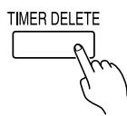
Se o botão DELETE (Apagar) for premido durante os passos **3** ou **4**, a hora de funcionamento do dia seleccionado é apagada. Se forem seleccionados todos os dias, as horas de funcionamento de todos os dias são apagadas.
