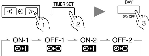
Pulse los botones de ajuste de la hora para fijarla y, a continuación, pulse el botón de ajuste (SET) para confirmar la selección, y proceda con el siguiente ajuste de la hora de conexión (ON) o de desconexión (OFF).
