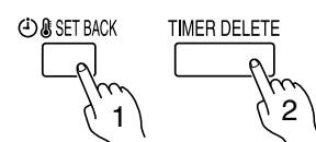
Pulse de nuevo el botón de cambio de la temperatura (SET BACK), y luego pulse el botón de borrado (DELETE) mientras aparece la pantalla de confirmación del cambio. Aunque pulse nuevamente el botón de cambio de la temperatura (SET BACK), se cancelará el temporizador de la misma.
