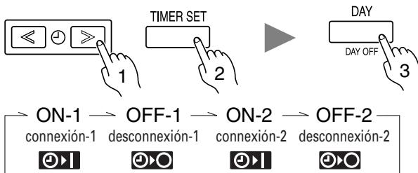
Pulse los botones de ajuste de la hora para fijarla y, a continuación, pulse el botón de ajuste (SET) para confirmar la selección, y proceda con el siguiente ajuste de la hora de conexión (ON) o de desconexión (OFF). Se pueden ajustar por día hasta dos horas de conexión (ON) y de desconexión (OFF). Pulse el botón del día (DAY) para finalizar el ajuste de la hora y vuelva a la configuración del día de la semana.
