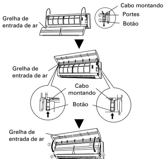
**Em relação aos filtros de limpeza do ar (O tipo de filtro de purificação do ar difere em função do modelo.)**
