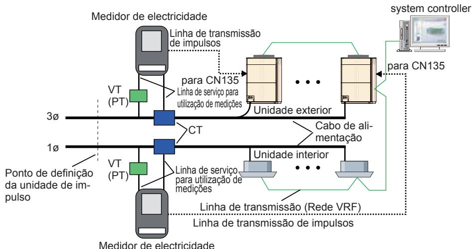
Os impulsos obtidos com medidores de electricidade especificados em unidades de impulsos são normalizados (normalmente 1 kWh/impulso) previamente e, em seguida, emitidos.
