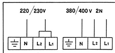
(o mesmo esquema de ligação eléctrica é presente nas proximidades da placa de terminais de alimentação). Desapertar o passa-fios e remontar o painel posterior do aparelho.
