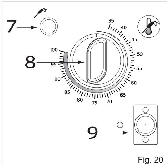
La cocción con aguja permite controlar de forma constante la temperatura dentro del producto.
