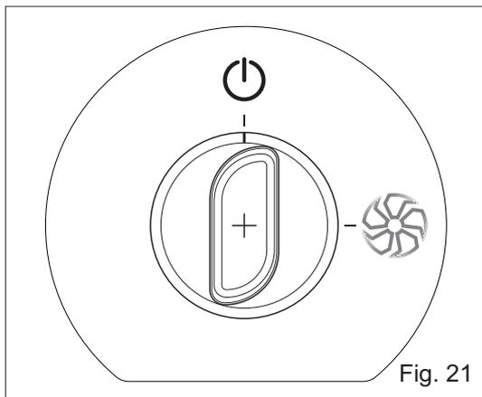
Una vez finalizado el ciclo de cocción, volver a colocar el selector de los ciclos de cocción en la posición que se indica en el dibujo 21 y volver a colocar todos los mandos en la posición inicial.
