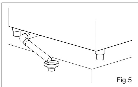
Para conectar el desagüe, instalar a la salida del aparato el embudo adjunto que asegure un flujo libre, el tubo de desagüe debe estar siempre abierto para evitar problemas de presión en la cámara (Fig. 5).
