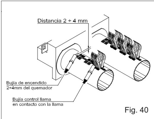
Regular el electrodo del control de la llama de manera que mientras funcionan los quemadores esté rodeado por la llama, de lo contrario no se activará la válvula del gas.
