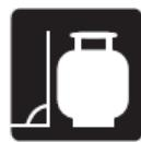
Non usare bombole di gas adagiate o capovolte. Non usare bombole arrugginite, ammaccate e/o con evidenti rigonfiamenti.
