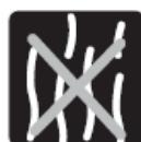
Questo scaldabagno non deve essere installato in prossimità di fonti di calore come forni elettrici, stufe, ecc.
