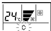
Pulse el botón de vaivén y dirección del flujo de aire vertical. El indicador de vaivén vertical parpadeará cada vez que se pulse el botón de vaivén y dirección del flujo de aire vertical.
