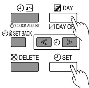
Appuyez sur le bouton DAY (DAY OFF) (JOUR (JOUR ARRET)) et le bouton SET (REGLER) simultanément pendant 2 secondes minimum pour activer la fonction de contrôle parental et verrouiller tous les boutons de la télécommande. Appuyez de nouveau sur les boutons pendant 2 secondes minimum pour désactiver la fonction de contrôle parental.
