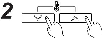
Appuyez simultanément sur les boutons de réglage de la température  $\wedge$  /  $\vee$  pendant au moins 5 secondes pour lancer l'auto-diagnostic.
