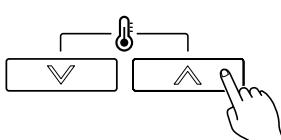
Appuyez sur les boutons de réglage de la température pour régler la température. (La plage de réglage de la température est identique à la plage du mode de fonctionnement.)
