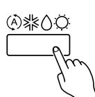
Appuyez sur le bouton de commande principale pour régler le mode de fonctionnement. Si DRY (SEC) est sélectionné, la vitesse du ventilateur sera réglée sur AUTO.
