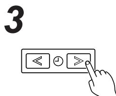
Appuyez sur les boutons de réglage de l'heure pour régler l'heure actuelle. Appuyez de façon répétée pour régler l'heure par incrément de 1 minute. Appuyez et maintenez enfoncé pour régler l'heure actuelle par incrément de 10 minutes.
