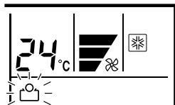
Pulse el botón de ahorro de energía (ENERGY SAVE) para iniciar o detener el funcionamiento del acondicionador de aire en el modo de ahorro de energía.
