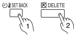
Pulse de nuevo el botón de cambio de la temperatura (SET BACK), y luego pulse el botón de borrado (DELETE) mientras aparece la pantalla de confirmación del cambio. Aunque pulse nuevamente el botón de cambio de la temperatura (SET BACK), se cancelará el temporizador del cambio de la misma.
