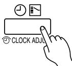
Pulse el botón de modo del temporizador y seleccione el temporizador de conexión (ON) o de desconexión (OFF).
