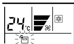
Pulse el botón de sensor térmico (THERMO SENSOR) para seleccionar si la temperatura de la sala se detecta en la unidad interior (sensor remoto) o en el mando a distancia.
