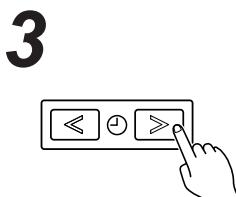
Pulse los botones de ajuste de la hora para establecer la hora actual. Presione el botón varias veces para ajustar la hora actual en incrementos de 1 minuto. Mantenga los botones pulsados para ajustar la hora actual en incrementos de 10 minutos.
