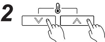
Pulse los botones de ajuste de temperatura  $\wedge$  /  $\vee$  simultáneamente durante 5 segundos o más para iniciar la autodiagnosis.
