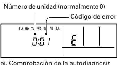
**3** Pulse los botones de ajuste de temperatura simultáneamente durante 5 segundos o más para detener la autodiagnosis.
