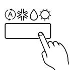
Pulse el botón de control de funciones para ajustar el modo de funcionamiento. Si selecciona deshumectación (DRY), la velocidad se ajustará en automático (AUTO).
