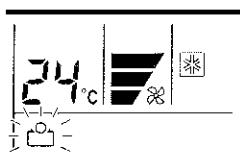
Pulse el botón de ahorro de energía (ENERGY SAVE) para iniciar o detener el funcionamiento del acondicionador de aire en el modo de ahorro de energía.
