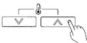
Pulse los botones de ajuste de la temperatura para ajustar la misma. (El margen del ajuste de la temperatura es el mismo que para el modo de funcionamiento.)
