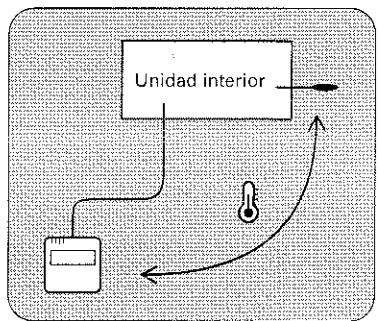
Pulse el botón de sensor térmico (THERMO SENSOR) para seleccionar si la temperatura de la sala se detecta en la unidad interior (sensor remoto) o en el mando a distancia.
