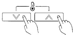
Pulse los botones de ajuste de temperatura  $\wedge$  /  $\vee$  simultáneamente durante 5 segundos o más para iniciar la autodiagnosis.
