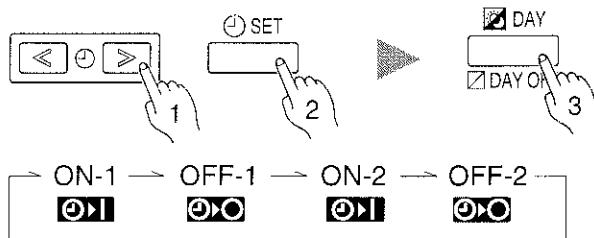
Pulse los botones de ajuste de la hora para fijarla y, a continuación, pulse el botón de ajuste (SET) para confirmar la selección, y proceda con el siguiente ajuste de la hora de conexión (ON) o de desconexión (OFF).
