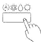
Pulse el botón de control de funciones para ajustar el modo de funcionamiento. Si selecciona deshumectación (DRY), la velocidad se ajustará en automático (AUTO).
