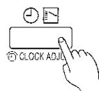
Pulse el botón de modo del temporizador (CLOCK ADJUST) durante 2 segundos o más. El indicador de la hora en el mando a distancia parpadeará.
