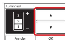
Lorsque [OK] est touché, l'affichage revient sur l'écran « Réglage du rétro éclairage ».
