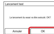
Une fois que l'écran de transmission s'est affiché, l'affichage revient sur l'écran « Maintenance » et le lancement test démarre. Le lancement test s'arrête automatiquement au bout d'environ 1 heure.
