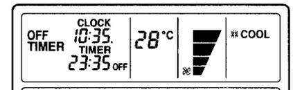
**Ejemplo:** Cuando se ajusta el temporizador para desconexión (OFF TIMER) a las 23:35
