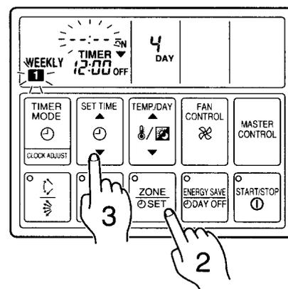
**Ejemplo:** Anulación de las horas de conexión (ON) y desconexión (OFF) para el día 4 (jueves).
