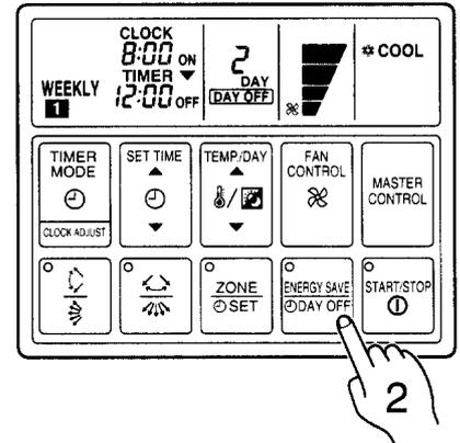
**Ejemplo:** Desactivación de los ajustes programados para el día 2 (martes)
