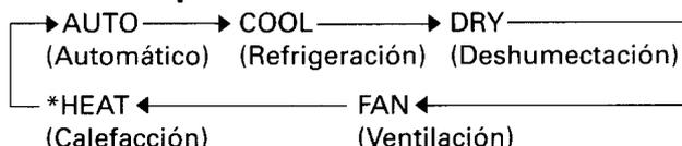
Los modos automático (AUTO) y de ventilación (FAN) no pueden utilizarse en el "MODELO DE REFRIGERACIÓN Y CALEFACCIÓN" sin ajuste alguno de cambio automático (AUTO CHANGEOVER).
