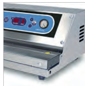
Puesta en funcionamiento y apertura barra soldante manual.
