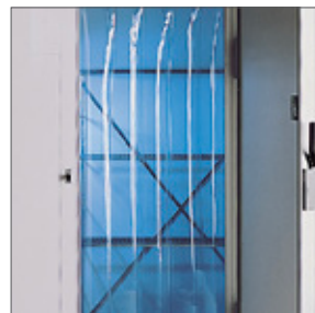
Cortina de lamas de plástico. Preservan la temperatura interior durante las aperturas de puertas. El espesor de cada lama es 1,8 mm y la anchura es de 20 cm.
